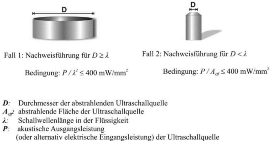
**Abbildung 1: Fallunterscheidung bezüglich der Schallquellenabmessung gegenüber der Wellenlänge**
